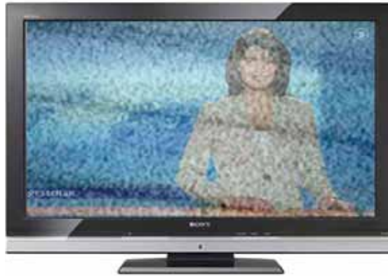
Bildstörung im analogen Fernsehempfang durch terrestrisches Digitalradio
